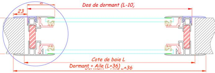
Modèle RT2 avec triple vitrage
